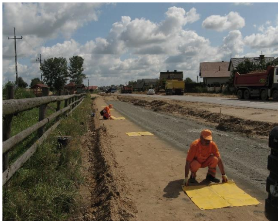
Rozmieszczenie tacek pomiarowych
