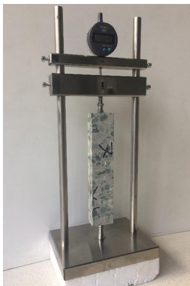
Rys.6.1. Widok próbki wyciętej z odwiertu z nawierzchni S8_W-P wraz z reperami (a) oraz wykres zmiany średniej długości trzech badanych próbek betonu w kolejnych dniach prowadzenia pomiaru przy przechowywaniu próbek w 1 N roztworze NaOH w temp. 80°C (b)
