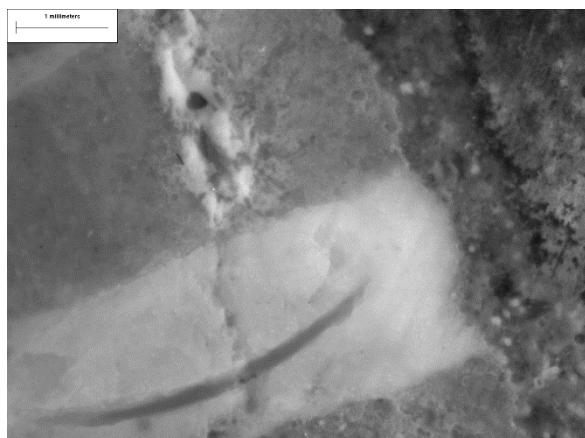
Rys.6.3 Widok wydzielin na powierzchni próbek betonu i zmiękczonego ziarna kwarcytu po wycięciu z roztworu NaOH
