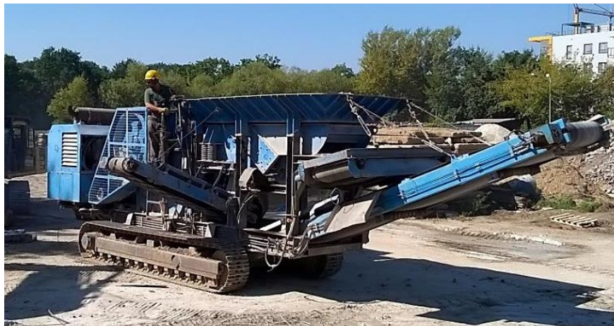
Rys.3. Przykładowa kruszarka mobilna na podwoziu gąsienicowym
