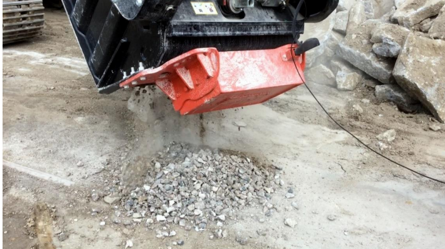
Rys.4. Przykładowa kruszarka montowana do ramienia koparki
