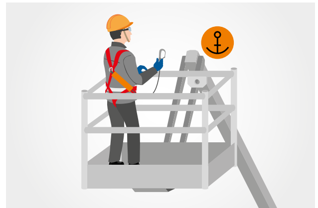
Rys. 4. Punkt kotwiczenia w podnośniku koszowym
