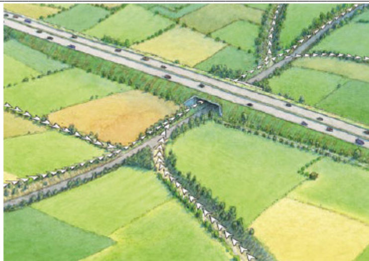
Rys. 4.21.17 Przykład wykonania nasadzeń naprowadzających nietoperze na przejazd pod drogą [91]
