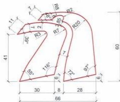
Rysunek nr 1 - Schemat wywietrznika pokrywy (włazu studni) kablowych kanału technologicznego wraz z rozmieszczonym logo oraz otworami wentylacyjnymi.
