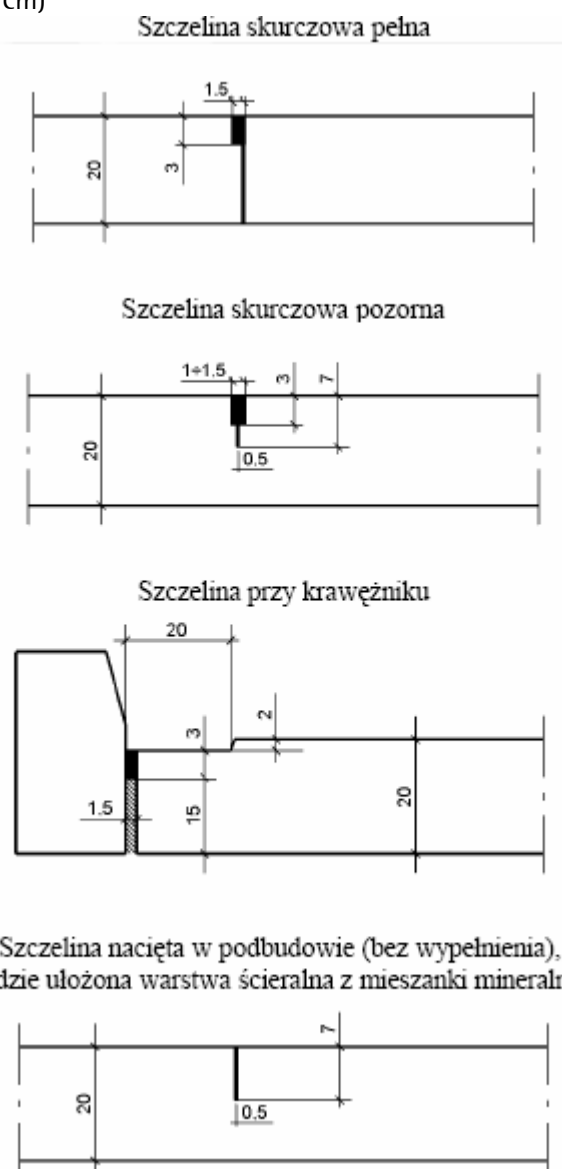
Rys. 1.1. Przykłady konstrukcji szczelin w podbudowie z betonu cementowego (wymiar w cm)
