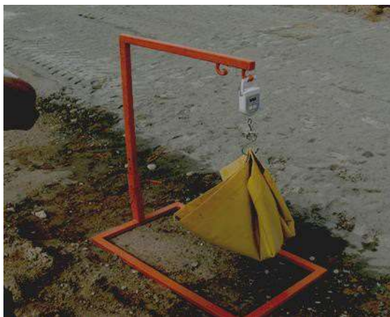
Ważenie tacki pomiarowej ze spoiwem
