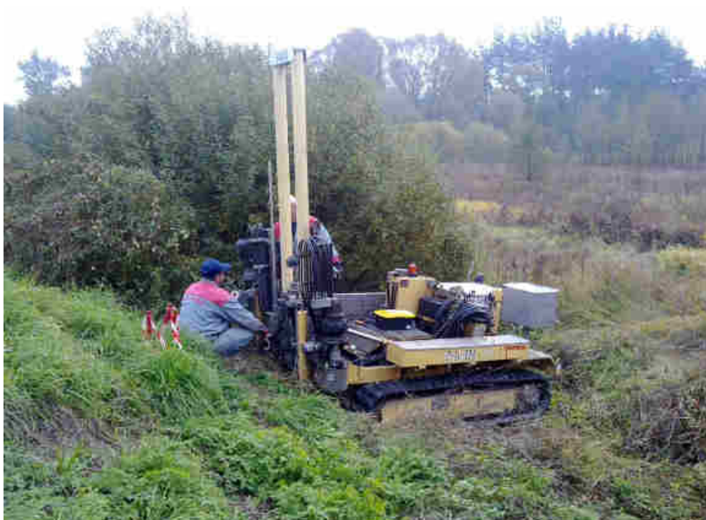
Fot.2 Urządzenie hydrauliczne (PAGANI TG-63-200) wykonujące sondowanie CPT-12
