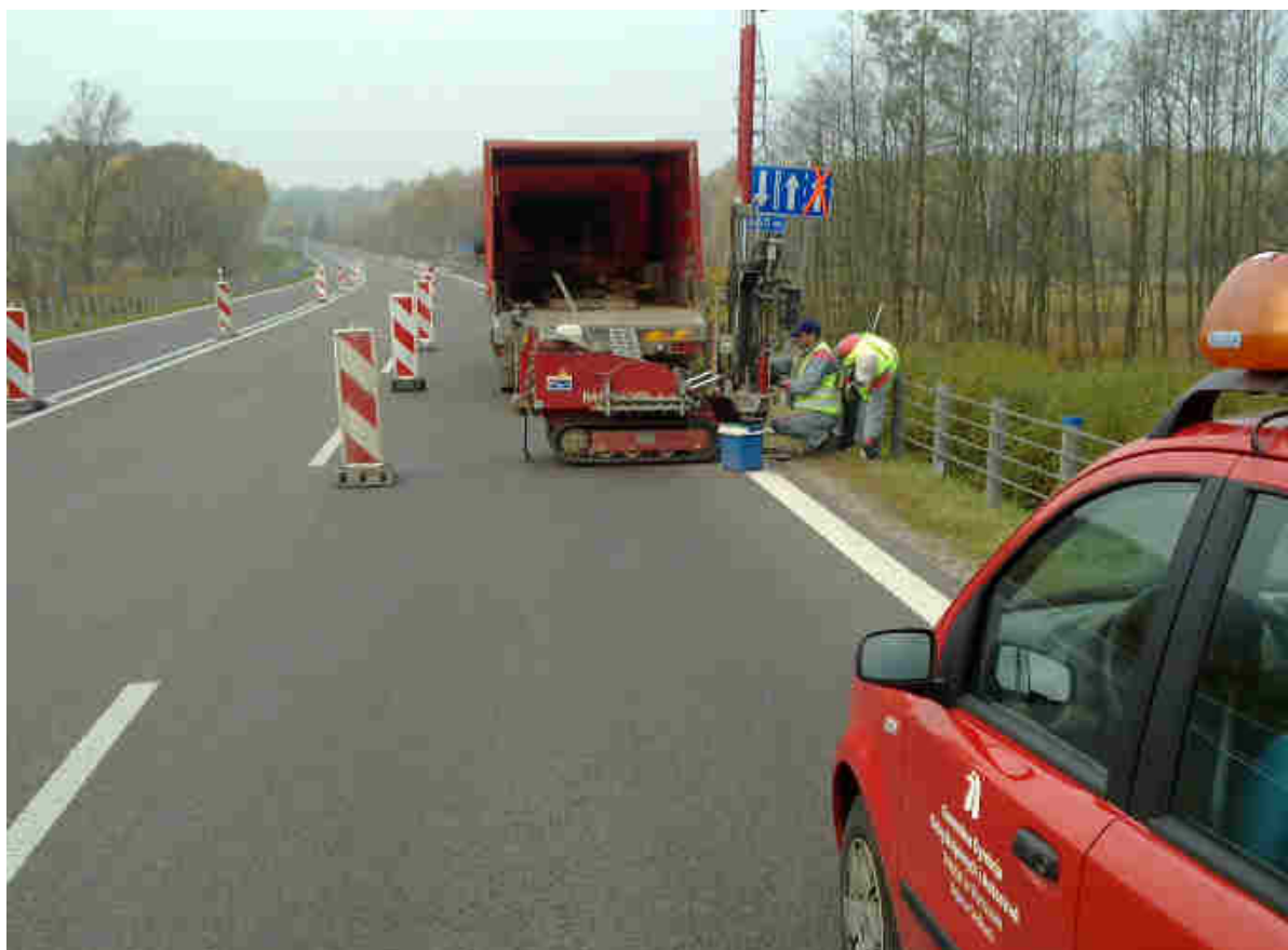
Fot.3 Urządzenie hydrauliczne (PAGANI TG-63-150) wykonujące sondowanie CPT-20
