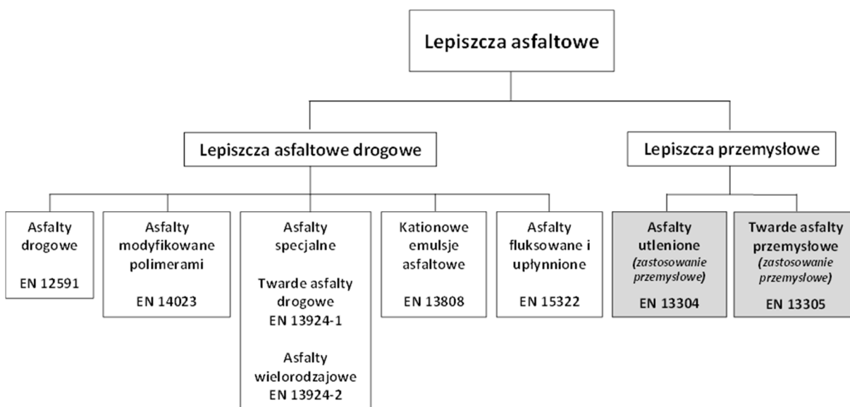
Rysunek 4.1 Klasyfikacja lepiszczy asfaltowych
