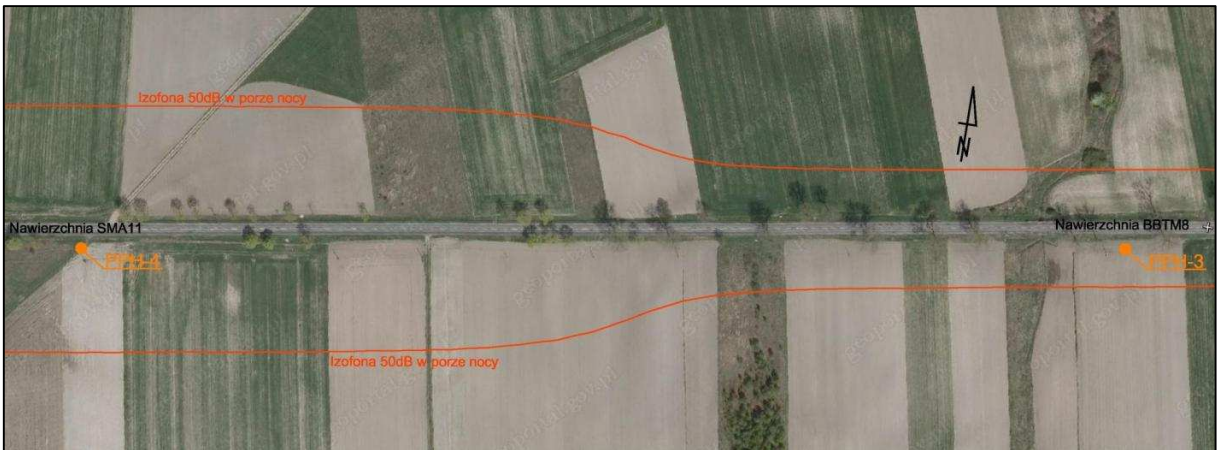
Rysunek 5.12 Wyniki analiz akustycznych w postaci emisji równoważnego poziomu dźwięku reprezentowanego przez izofonę 50dB dla pory nocy – porównanie oddziaływania ruchu odbywającego się po nawierzchni BBTM8 i SMA11 (efekt zmniejszenia poziomu hałasu w pierwszym roku eksploatacji -6.5 dB) [6]
