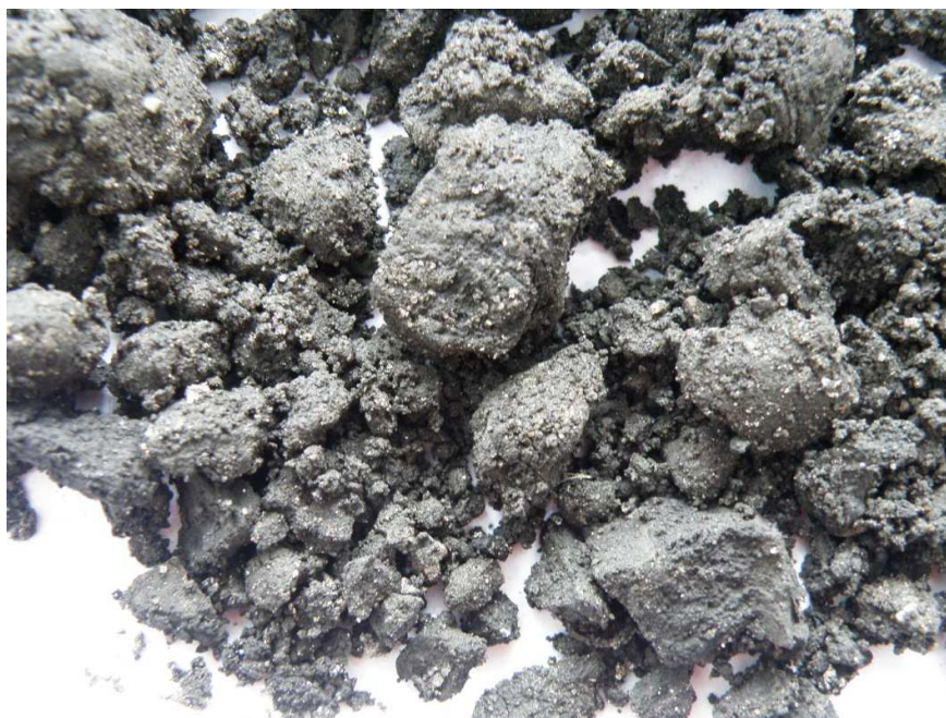
Fotografia 5.1 Materiał pobrany (odessany) w wyniku czyszczenia z nawierzchni porowatej
