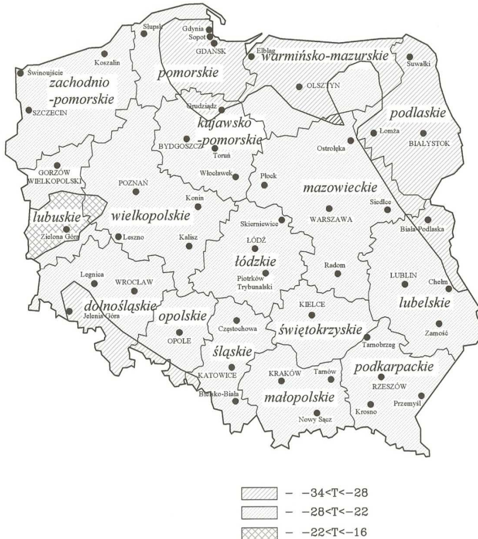
Rysunek 4.8 Strefy klimatyczne Polski występowania niskich temperatur w nawierzchni drogowej (WT-2, 2008)
