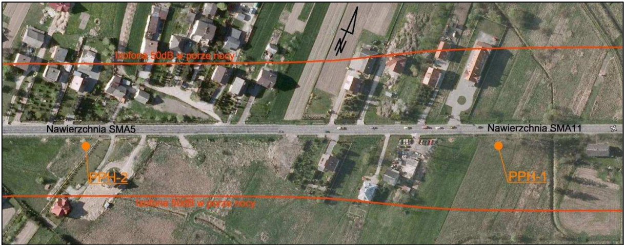
Rysunek 5.11 Wyniki analiz akustycznych w postaci emisji równoważnego poziomu dźwięku reprezentowanego przez izofonę 50 dB dla pory nocy – porównanie oddziaływania ruchu odbywającego się po nawierzchni SMA5 i SMA11 (efekt zmniejszenia poziomu hałasu w pierwszym roku eksploatacji -2.0 dB) [6]
